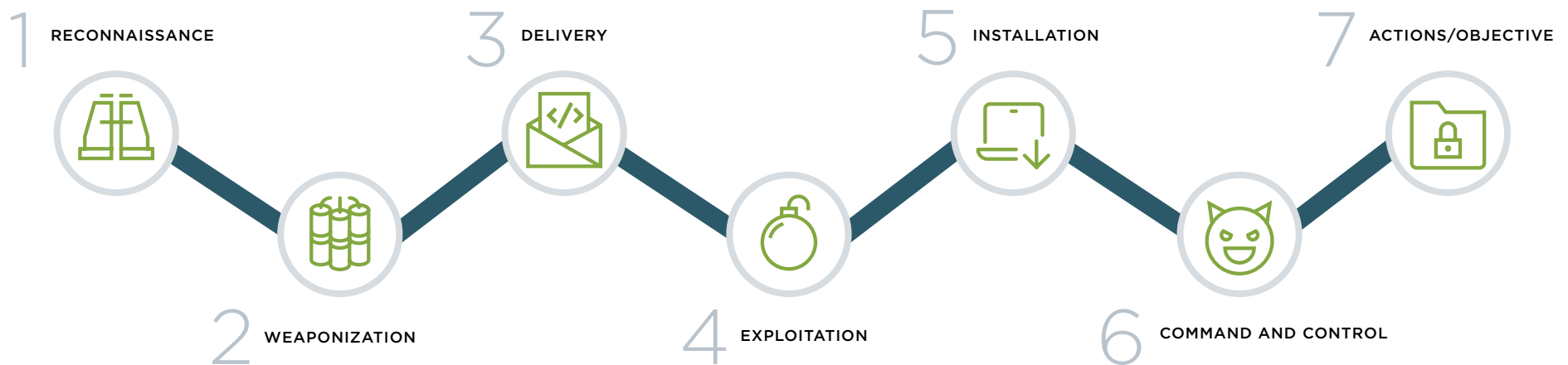
Abbildung 1: Die Cyber Kill Chain, beginnend mit der Erkundung und der Etablierung im Netzwerk, endend mit der Exfiltration oder anderem. Eine gute MDR-Lösung bietet Erkennung an mehreren Stationen.
